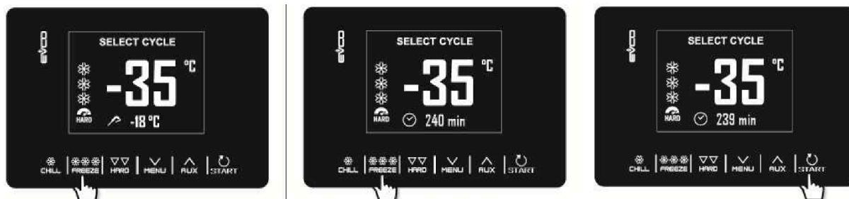
Ejemplo de ciclo de congelación por chorro controlado por temperatura (aguja), conversión a ciclo controlado por tiempo, cambio rápido de la duración del ciclo de congelación por chorro y del ciclo de inicio.
