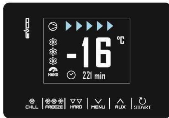
Al finalizar el ciclo de abatimiento/congelación, cuando la sonda de aguja ha alcanzado la temperatura adecuada o se ha terminado el periodo de tiempo, suena el zumbador y comienza la fase de conservación. Si el ciclo a temperatura controlada no se completa en el tiempo previsto, se notificará el problema mostrando un mensaje de alarma.
