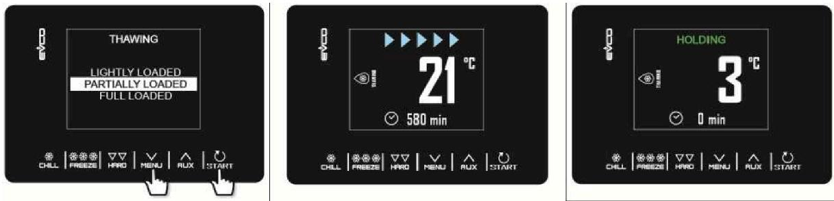
El ciclo de descongelación se gestiona en función de la cantidad de producto a descongelar que se carga en la unidad en relación con la cantidad máxima especificada por el fabricante. Para simplificar, las cantidades de carga que se pueden seleccionar se dividen en tres bandas, para cada una de las cuales el controlador cargará tres conjuntos diferentes de parámetros predefinidos, de acuerdo con el siguiente esquema:
