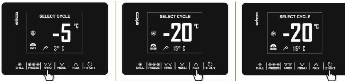
Ejemplo de un ciclo de abatimiento controlado por temperatura (aguja), adición de una fase dura, cambio rápido del setpoint de la cabina para la fase blanda e inicio del ciclo.
